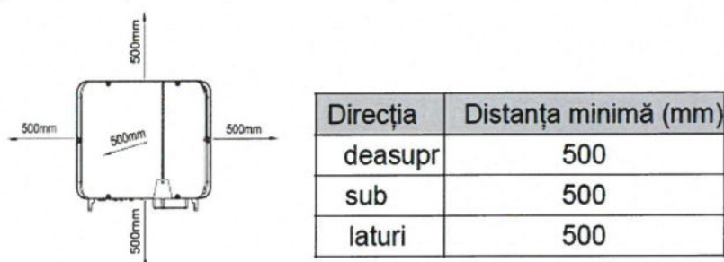
Figura 5.3 Distanțelor minime - În cazul unui singur inverter
